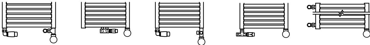
Radiator forbundet til centralvarmeanlægget, til hvilken et yderligere varmeelement skal installeres.
