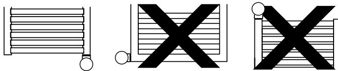
Radiator udelukkende opvarmet med et varmeelement, som ikke er forbundet til et centralt varmesystem.
