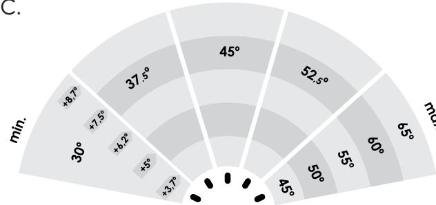
For at tilpasse temperaturintervallet, så tag apparatet ud af stikkontakten, og sæt det i igen, mens du trykker på knappen. En enkelt diode starter med at blinke på skærmpanelet. Anvend og knapperne for at indstille en af de 5 mulige maks. temperaturer. Den første diode betyder 45° C. De følgende dioder refererer til de følgende maks. temperaturer: 50° C 55° C 60° C og 65° C.
