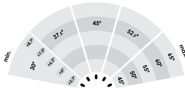
For å endre temperaturspennet, koble fra apparatet og plugg det inn igjen, mens du trykker på knappen. En diode vil begynne å blinke på skjermpanelet. Brukknapper for å angi en av de 5 mulige temperaturene. Den første dioden står for 45° C. Følgende dioder refererer til følgende maksimumstemperaturer: 50° C, 55° C, 60° C og 65° C. Apparatet vil gå tilbake til de siste innstillingene etter at knappen er trykket på.
