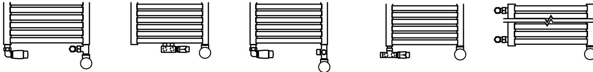
Radiator koblet til sentralvarmesystemet der hver varmeelementenhet installeres i tillegg. Installasjon av sentralvarme må være utstyrt med ventiler som muliggjør frakopling av radiatoren fra resten av systemet.
