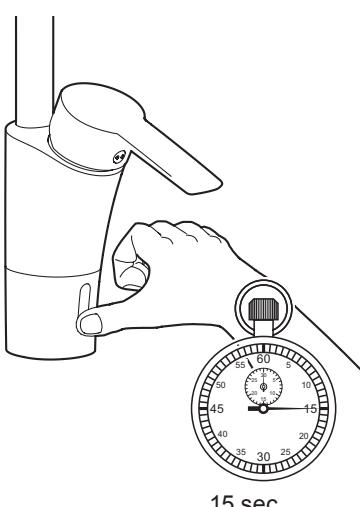
**Mora Cera Duo****SE - Avstängd spolning****EN - Suspended / turned off flushing****NO - Avstengt spyling****DK - Sensorstyring slået fra****FI - Huuhtelu suljettu****SE**
