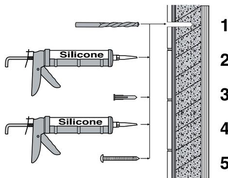
**Skruvfästningar i våtzone 1 ska göras i massiv konstruktion såsom betong, regler, särskild konstruktionsdetalj eller i Våtrumsvägg 2012.**
