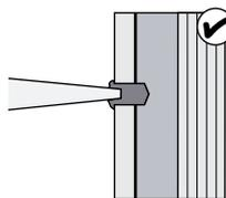
Fyll hela hålet med åldersbeständig tätningssmassa.
