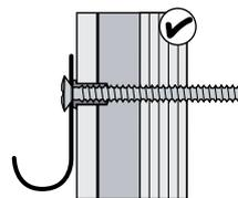
Använd VVS-skruv. Skruva genom plywoodskivan.
